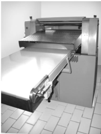
Equipamento que auxilia no processo de laminação, ou seja, no intercalar de massa e gordura em camadas milimetricamente finas, como no *croissant* e na massa folhada.
