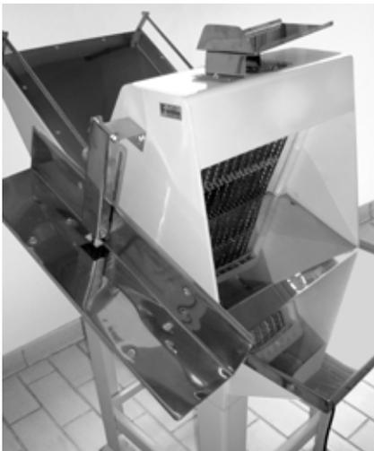
A fatiadeira de pão é um equipamento elétrico empregado para cortar em fatias os diversos tipos de pães (ALMEIDA, 1998). As lâminas são onduladas de um lado e lisas do outro, dentadas e cortantes. Estão dispostas verticalmente umas ao lado das outras e funcionam em movimento de vai e vem, intercaladamente, ou seja, as lâminas movem-se alternadamente em movimento de vibração.
