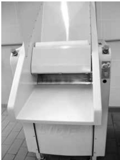
Equipamento constituído por dois rolos de aço inox (superior e inferior) que giram em sentidos contrários e lançam a massa para dentro do espaço existente entre eles, sendo que essa distância entre um rolo e outro pode ser regulada de acordo com a necessidade do produto, como forma de ajustar a espessura da massa. Os rolos são movidos por motores, e a fonte de energia é elétrica.
