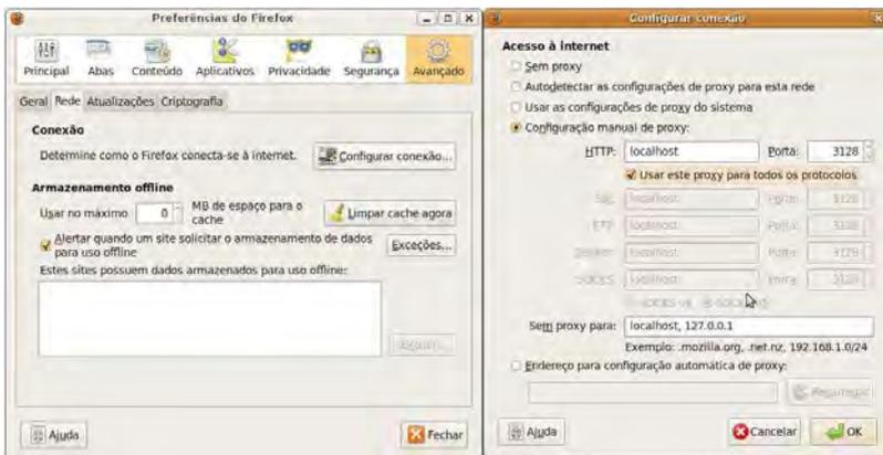
Figura 22.2: Configurando o Firefox para acessar o Squid
